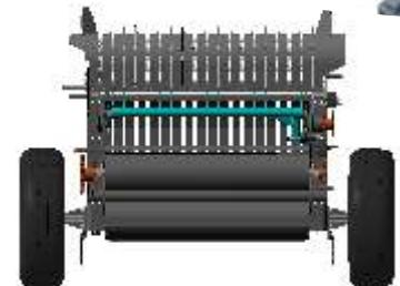
Укладчик повышает плотность рулонов и надежность работы
