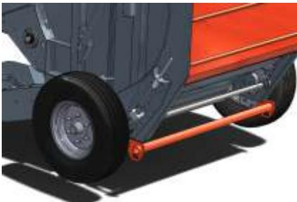
Пружинный механизм натяжки транспортёра
